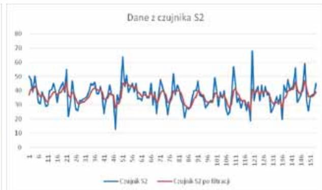
Rys. 4. Przebiegi przed i po filtracji Kalmana – S2
