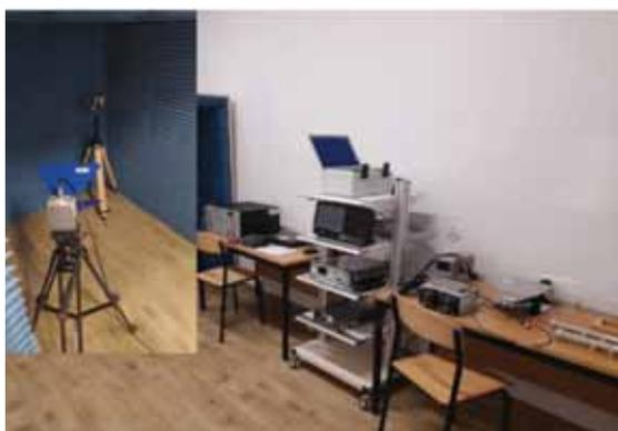
Tor nadawczy zapewnia generację sygnału RF o regulowanym wzmocnieniu na fali ciągłej lub z modulacją impulsową. Sygnał doprowadzony jest do elementu nadawczego emitującego falę elektromagnetyczną dzięki czemu powstaje pole EM w przestrzeni pomiarowej. W torze nadawczym zapewniona jest metrologiczna kontrola mocy sygnału doprowadzonego do anteny (lub komory TEM). Tor pomiarowy zapewnia kontrolę parametrów pola EM poprzez pomiar jego składowej elektrycznej.
