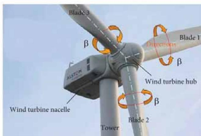
Rys. 1. Turbina wiatrowa o zmiennym kącie ustawienia łopat wirnika (variable-pitch wind turbine)
