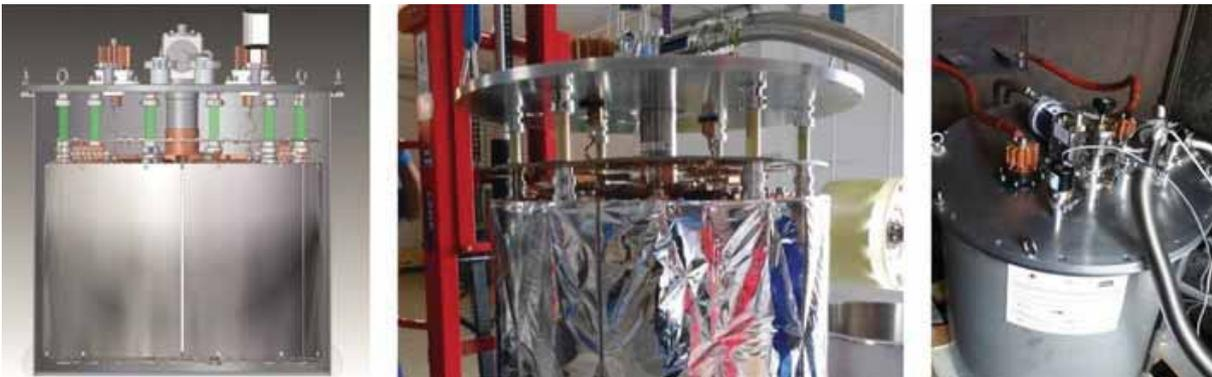
**Rys. 1.** Nadprzewodnikowy ogranicznik prądu zwarciového typu rezystancyjnego chłodzony kontaktowo (Instytut Elektrotechniki, Uniwersytet Zielonogórski i Frako-Term sp. z o.o.)
